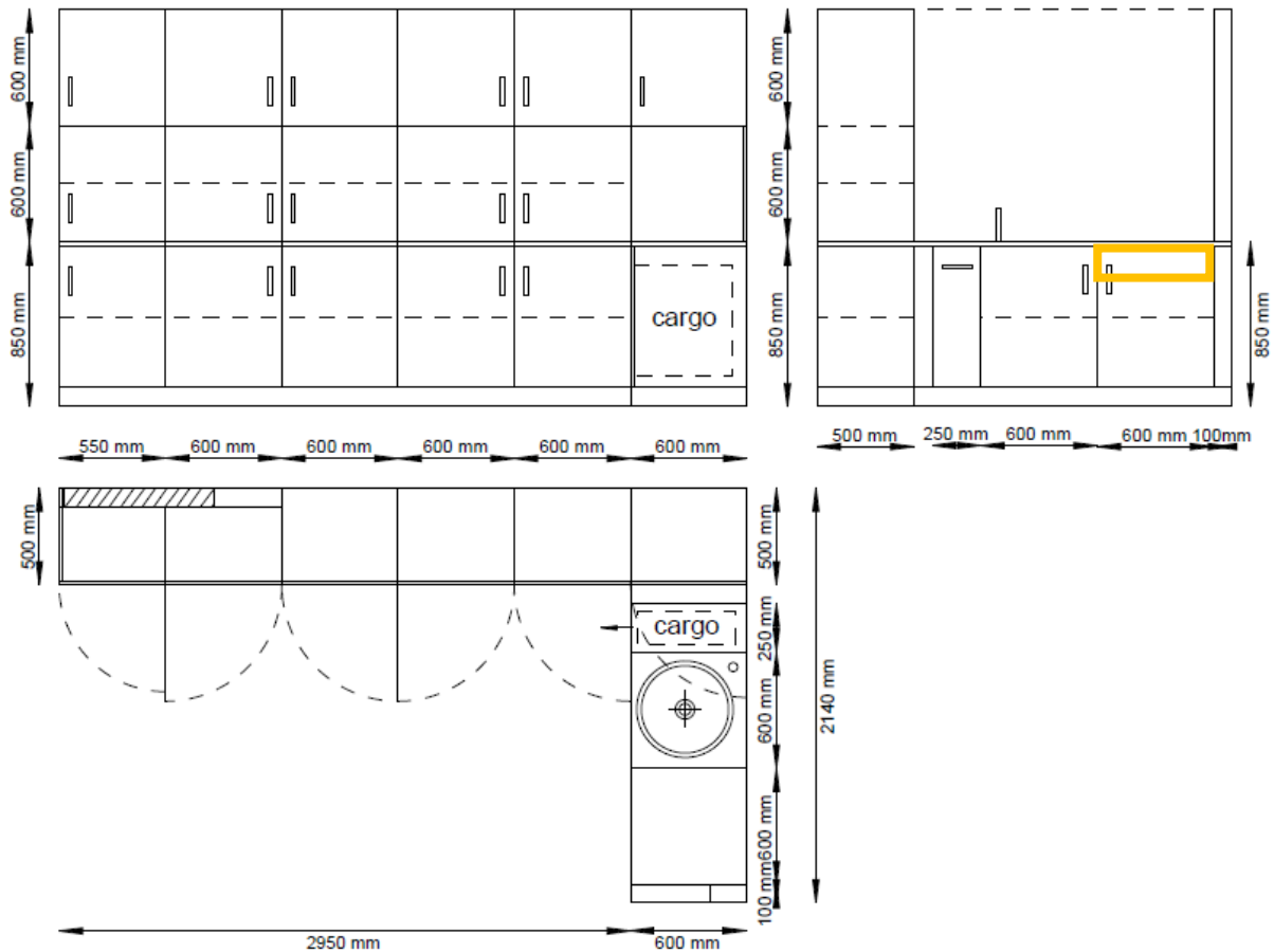
Rys. 15. Zabudowa zlewozmywaka w sterowni 94 (szuflada na pomarańczowo)
