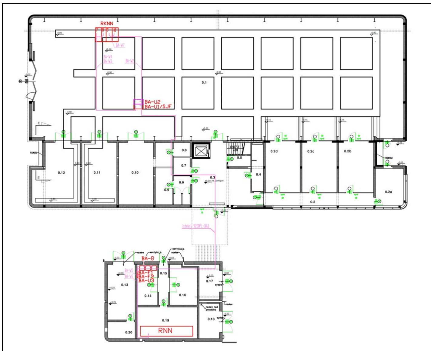
Rys. 2. Rozmieszczenie elementów zasobnika BA w Laboratorium LINTE^2
