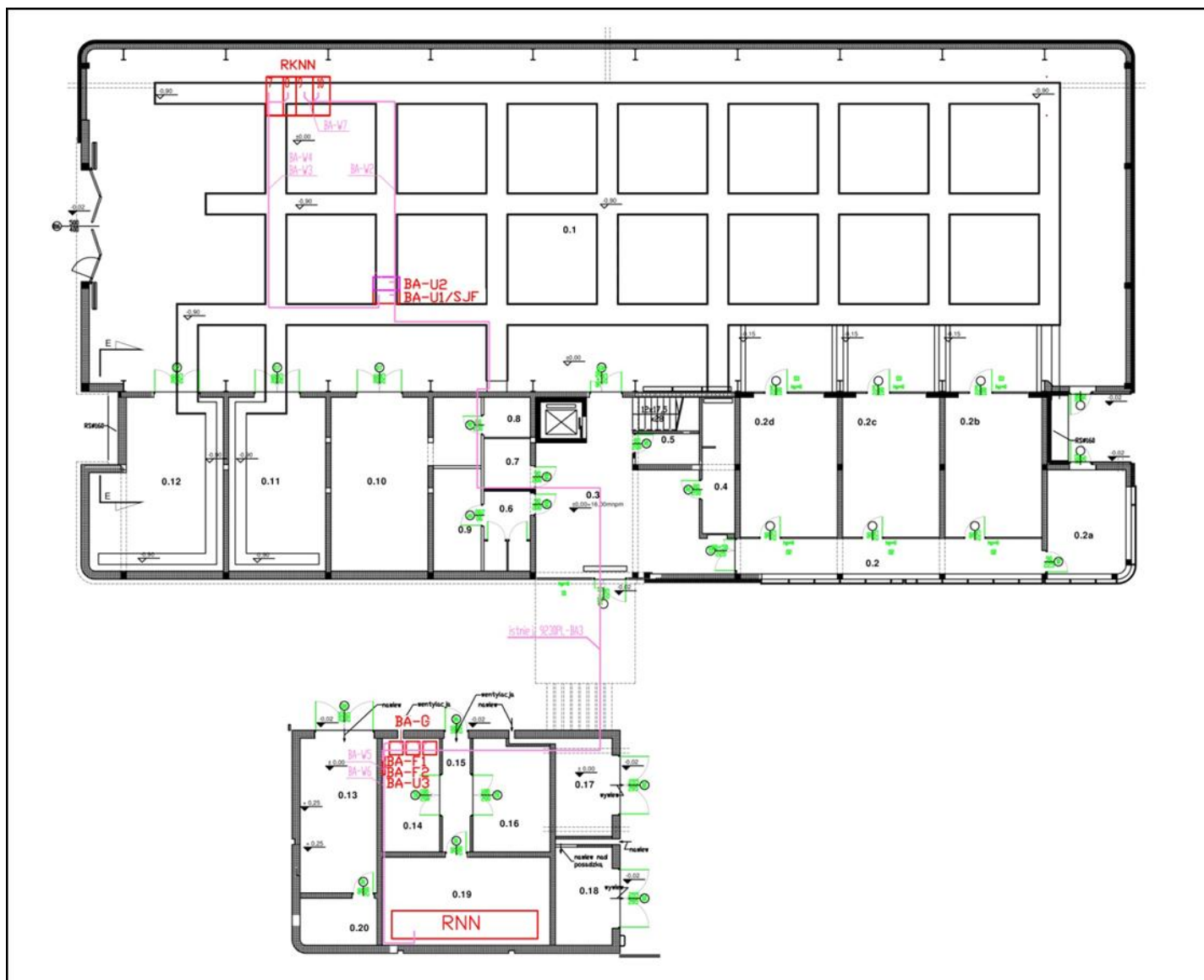
Rys. 2. Rozmieszczenie elementów zasobnika BA w Laboratorium LINTE^2
